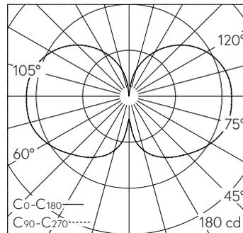
LED 4000 K 13.8 W 1384 lm-h / CIE Flux 19 43 70 52 100 / C11 selon DIN 5040
