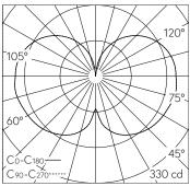
LED 3000 K 26 W 2699 lm-h / CIE Flux 22 47 72 54 100 / C11 selon DIN 5040
