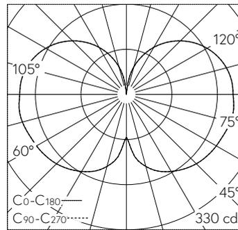
LED 4000 K 26 W 2806 lm-h / CIE Flux 22 47 72 54 100 / C11 selon DIN 5040
