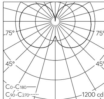
LED 3000 K 59,5 W 5920 lm-h / CIE Flux 22 47 73 55 100 / C11 selon DIN 5040
