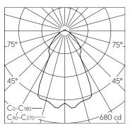
LED 4000 K 11.8 W 853 lm-h 58° / CIE Flux 67 89 97 95 100 / A62 selon DIN 5040
