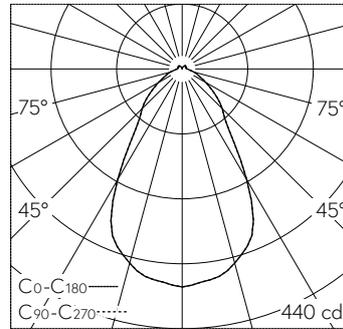
LED 4000 K 5.9 W 590 lm-h 62° / CIE Flux 67 88 96 93 100 / A62 selon DIN 5040
