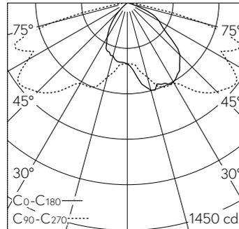
LED 3000 K 19 W 2248 lm-h / CIE Flux 38 75 96 100 100 / A30 selon DIN 5040
