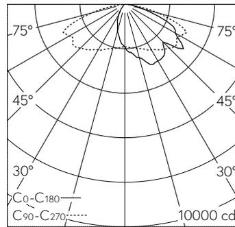
LED 4000 K 71 W 9076 lm-h / CIE Flux 33 67 93 100 100 / A20 selon DIN 5040
