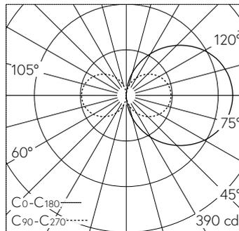
LED 3000 K 15.3 W 1325 lm-h / CIE Flux 14 38 67 50 100 / C11 selon DIN 5040
