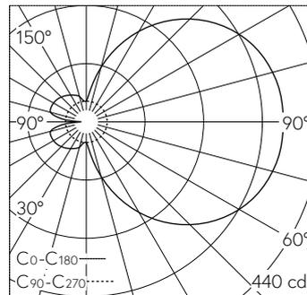
LED 4000 K 19.1 W 1600 lm-h / CIE Flux 17 42 69 50 100 / C11 selon DIN 5040
