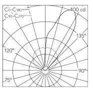
LED 2700 K 10.5 W 453 lm-h / CIE Flux 0 0 32 0 100 / E84 selon DIN 5040
