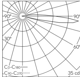
LED 2700 K 1.3 W 20 lm-h / CIE Flux 0 1 2 73 100 / B01 selon DIN 5040
