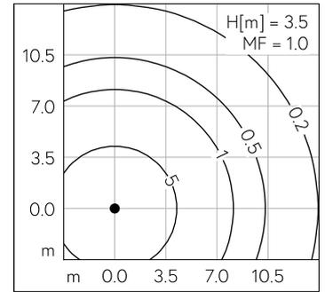
LED 3000 K 18 W 1617 lm-h H = 3.5 m / CIE Flux 31 59 82 81 100 / B21 selon DIN 5040
