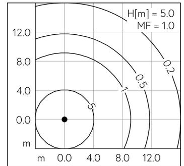
LED 4000 K 18 W 1701 lm-h H = 4.5 m / CIE Flux 31 59 82 81 100 / B21 selon DIN 5040
