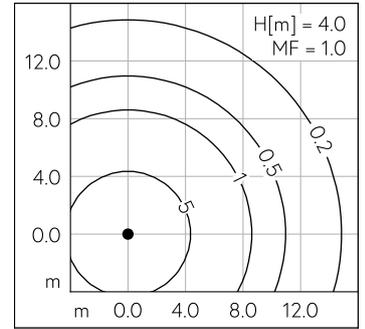
LED 4000 K 18 W 1701 lm-h H = 3.5 m / CIE Flux 31 59 82 81 100 / B21 selon DIN 5040
