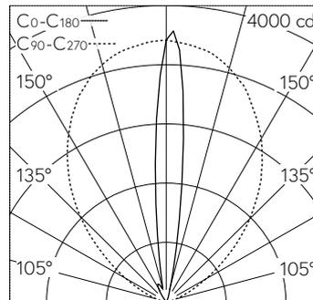
LED 3000 K 15.5 W 1341 lm-h / CIE Flux 0 0 0 100 / E84 selon DIN 5040
