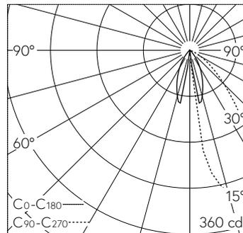
LED 3000 K 2.5 W 146 lm-h / CIE Flux 80 97 100 100 100 / A70 selon DIN 5040
