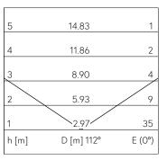
LED 4000 K 2.7 W 98 lm-h 112° / CIE Flux 0 0 0 0 100 / E83 selon DIN 5040
