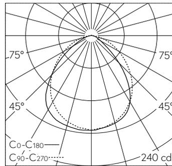
LED 3000 K 4.9 W 404 lm-h / CIE Flux 57 87 97 99 100 / A50 selon DIN 5040
