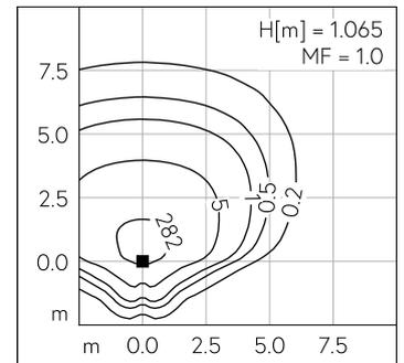
LED 4000 K 22 W 2778 lm-h / CIE Flux 40 81 98 100 100 / A30 selon DIN 5040
