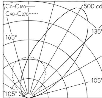
LED 2700 K 9.5 W 769 lm-h / CIE Flux 0 0 0 100 / E83 selon DIN 5040
