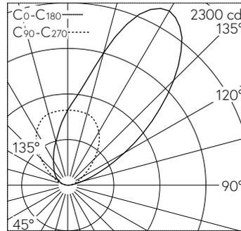
LED 2700 K 30 W 2705 lm-h / CIE Flux 0 0 0 100 / E84 selon DIN 5040
