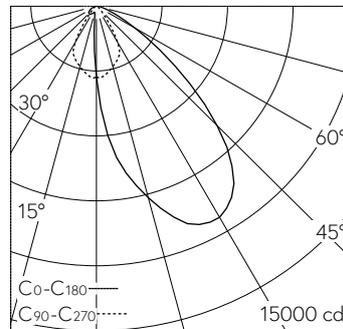
LED 4000 K 105 W 7742 lm-h / CIE Flux 72 96 100 100 100 / A60 selon DIN 5040
