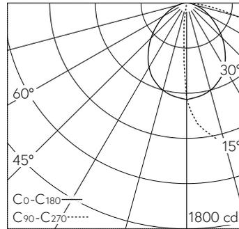
LED 3000 K 20.8 W 2511 lm-h / CIE Flux 41 78 96 100 100 / A30 selon DIN 5040
