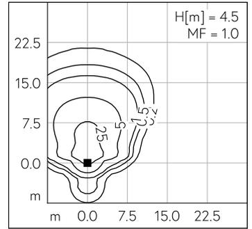
LED 4000 K 25 W 3350 lm-h H = 4 m / CIE Flux 36 71 97 100 100 / A30 selon DIN 5...
