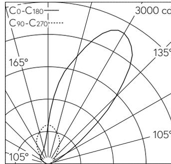
LED 3000 K 35.3 W 2695 lm-h / CIE Flux 0 0 0 100 / E84 selon DIN 5040
