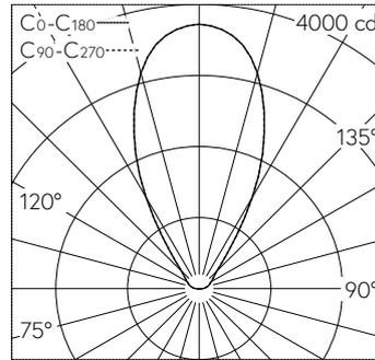
LED 3000 K 35.3 W 3292 lm-h / CIE Flux 0 0 10 1 100 / E04 selon DIN 5040
