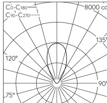
LED 4000 K 35.3 W 3477 lm-h / CIE Flux 0 0 10 1 100 / E04 selon DIN 5040
