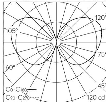
LED 4000 K 9.5 W 887 lm-h / CIE Flux 15 40 68 47 100 / C11 selon DIN 5040
