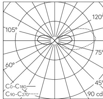
LED 3000 K 9.5 W 169 lm-h / CIE Flux 2 18 50 45 100 / C11 selon DIN 5040
