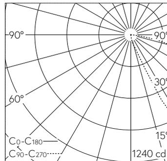
LED 3000 K 13.5 W 1113 lm-h / CIE Flux 25 71 94 100 100 / A20 selon DIN 5040
