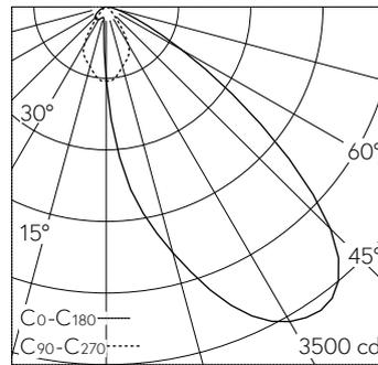
LED 3000 K 26.6 W 2438 lm-h / CIE Flux 66 95 99 100 100 / A60 selon DIN 5040
