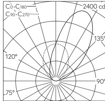
LED 3000 K 30.5 W 3318 lm-h / CIE Flux 0 0 0 100 / E84 selon DIN 5040
