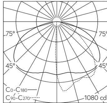
LED 3000 K 36 W 3796 lm-h / CIE Flux 43 77 96 100 100 / A30 selon DIN 5040
