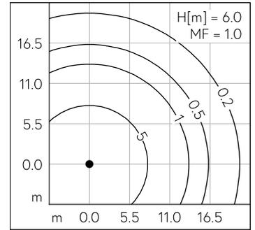
LED 3000 K 27 W 3428 lm-h H = 4.5 m / CIE Flux 34 71 93 99 100 / A20 selon DIN 5...
