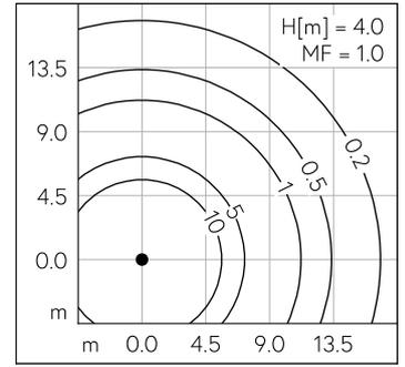
LED 3000 K 27 W 3428 lm-h H = 5 m / CIE Flux 34 71 93 99 100 / A20 selon DIN 5040
