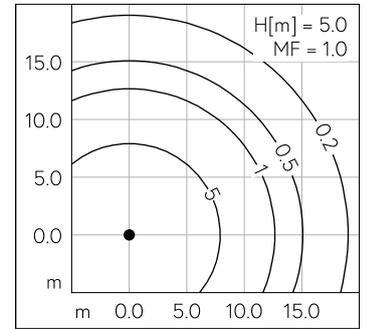
LED 4000 K 27 W 3601 lm-h H = 5 m / CIE Flux 34 71 93 99 100 / A20 selon DIN 5040
