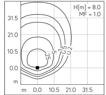
LED 3000 K 105 W 10587 lm-h H = 8 m / CIE Flux 42 79 96 100 100 / A30 selon DIN...
