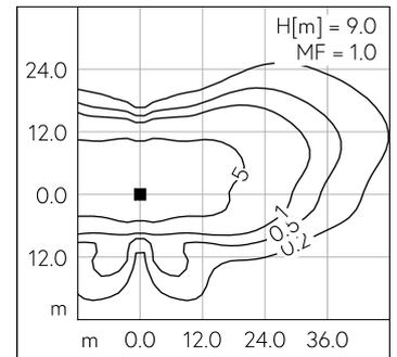
LED 4000 K 67 W 9422 lm-h H = 9 m / CIE Flux 34 66 93 100 100 / A20 selon DIN 5...
