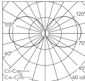
LED 3000 K 7 W 486 lm-h 126° / CIE Flux 9 32 62 47 100 / C11 selon DIN 5040
