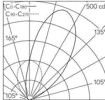
LED 3000 K 5.1 W 419 lm-h / CIE Flux 0 0 0 100 / E84 selon DIN 5040
