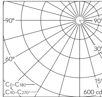
LED 4000 K 19 W 796 lm-h / CIE Flux 7 42 78 99 100 / A10 selon DIN 5040
