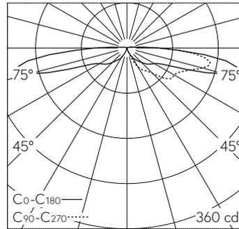
LED 3000 K 6 W 418 lm-h / CIE Flux 6 24 56 94 100 / A11 selon DIN 5040
