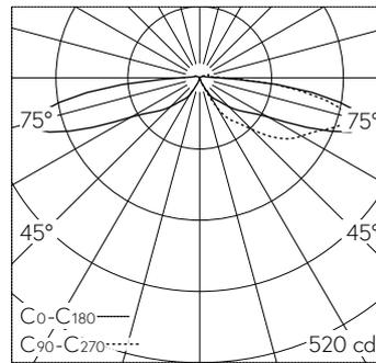
LED 4000 K 8 W 668 lm-h / CIE Flux 6 27 68 96 100 / A11 selon DIN 5040
