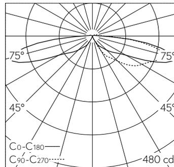
LED 3000 K 8 W 650 lm-h / CIE Flux 6 27 68 96 100 / A11 selon DIN 5040
