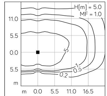
LED 4000 K 52 W 7376 lm-h H = 5 m / CIE Flux 38 75 96 100 100 / A30 selon DIN 5...
