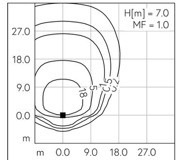
LED 4000 K 106 W 14534 lm-h H = 7 m / CIE Flux 35 73 96 100 100 / A30 selon DIN...
