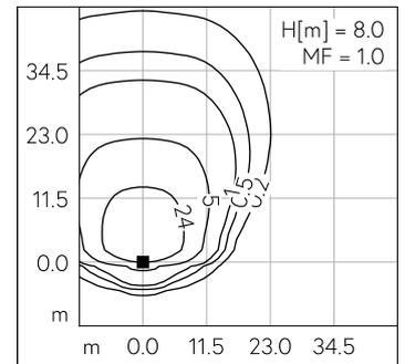
LED 3000 K 206 W 26436 lm-h H = 8 m / CIE Flux 34 72 96 100 100 / A30 selon DI...
