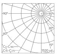
LED 3000 K 14.7 W 1354 lm-h / CIE Flux 7 39 78 98 100 / A10 selon DIN 5040
