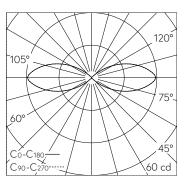
LED 3000 K 7 W 235 lm-h 198 $^{\circ}$  / CIE Flux 1 11 44 50 100 / C11 selon DIN 5040
