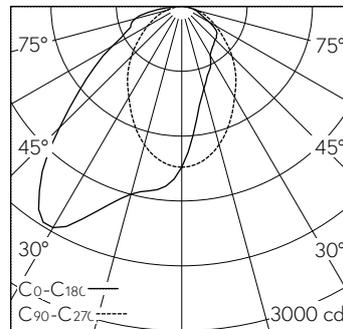
LED 4000 K 32 W 3800 lm-h / CIE Flux 51 81 95 100 100 / A40 selon DIN 5040
