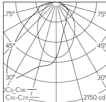
LED 4000 K 26 W 3100 lm-h / CIE Flux 51 81 95 100 100 / A40 selon DIN 5040
